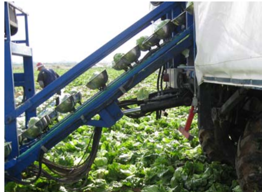
Brazo hidráulico de regulación de altura de la cabeza
