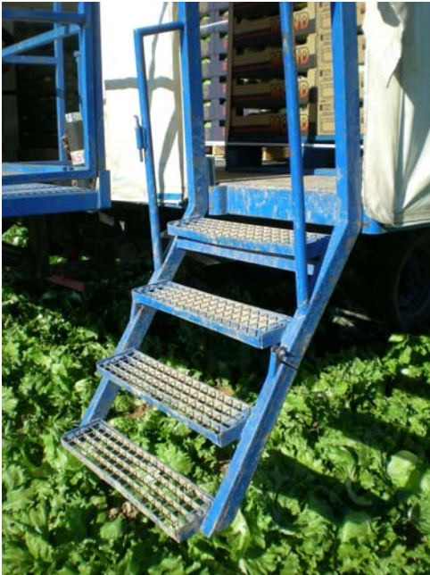
Escalera de acceso articulada
