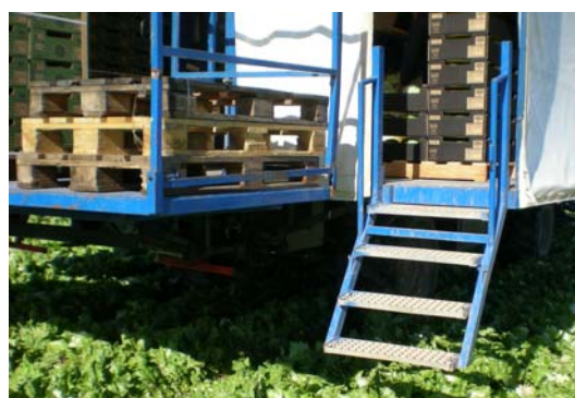
Escalera de acceso a la plataforma
