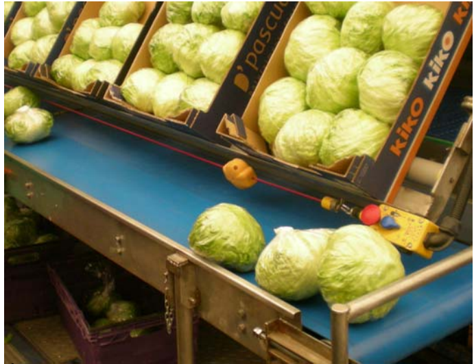
Organos de parada de emergencia en cinta transportadora
